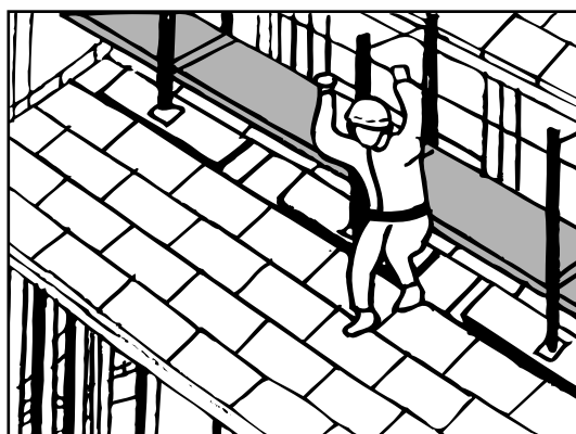
③ 作業中、足場から屋根面へ跳びおりたり、物を落としたりするとひび割れ、破損を生じ、雨漏り等のクレーム原因となりますので注意して下さい。
