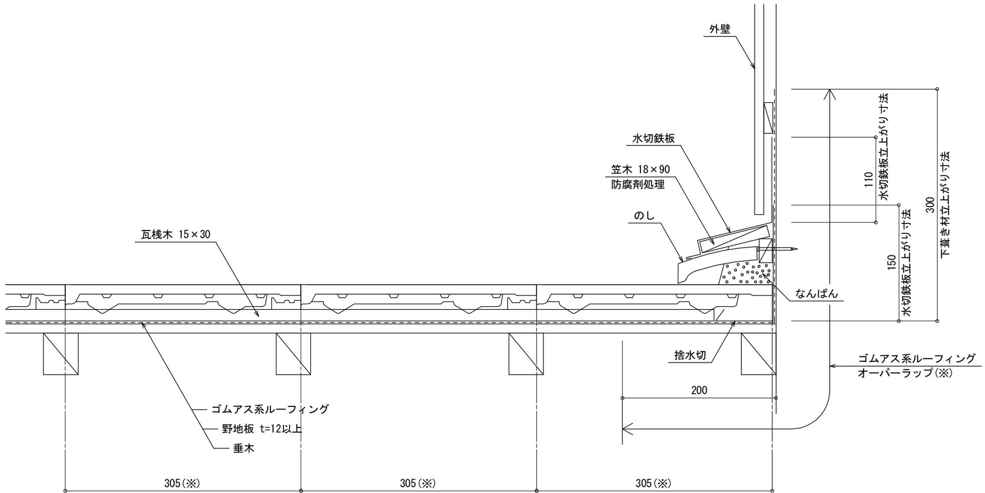
(※)瓦の特性上、桁行き方向の働き寸法はバラツキがあります。
