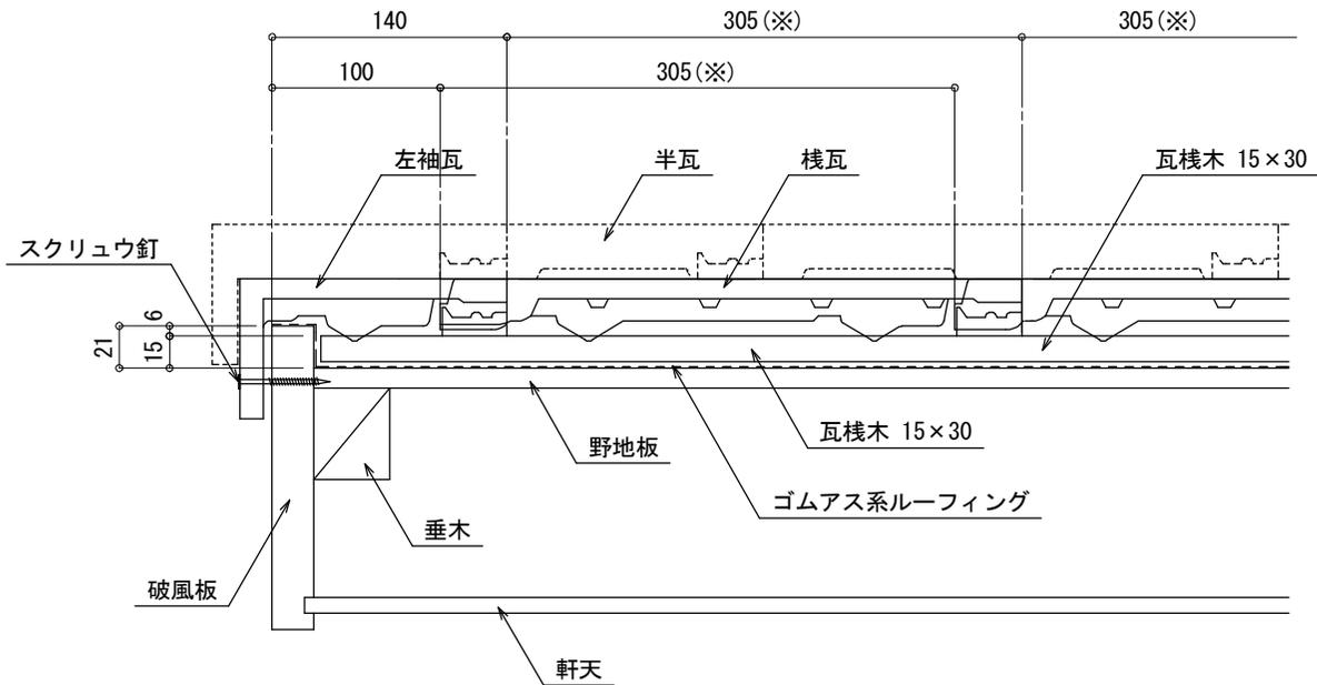
(※)瓦の特性上、桁行き方向の動き寸法はバラツキがあります。
